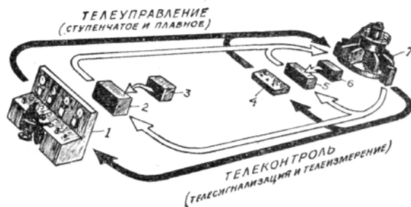
1 и 4 — щиты и пульты управления, 2 и 5 — органы сравнения и автоматического управления, 3 и 6 — задающие приборы, 7 — управляемая машина.
